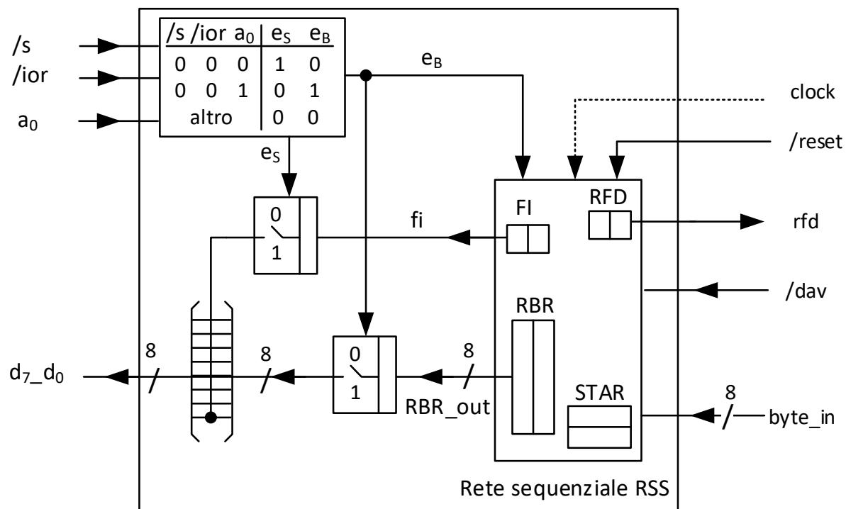
La RC interna deve, per prima cosa, generare i segnali di abilitazione per le tri-state quando il processore accede in lettura a RBR o RSR. Le due tri-state (una delle quali ha 8 bit) non sono mai in conduzione contemporaneamente, e sono entrambe in alta impedenza quando non ci sono accessi all'interfaccia. Inoltre, c'è una RSS, che gestisce l'handshake con il dispositivo e setta/resetta il flag
