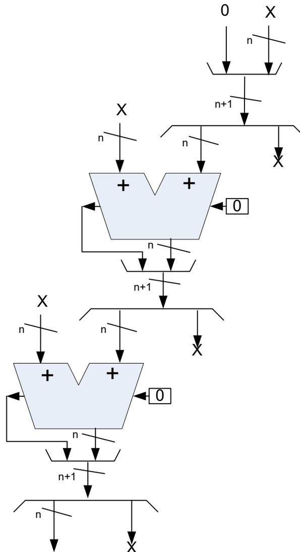
In questo modo, con **due** full adder ad  $n$  bit ce la facciamo. Nell'altro caso, ci vuole **un solo full adder**, ma ad  $n + 3$  bit.
