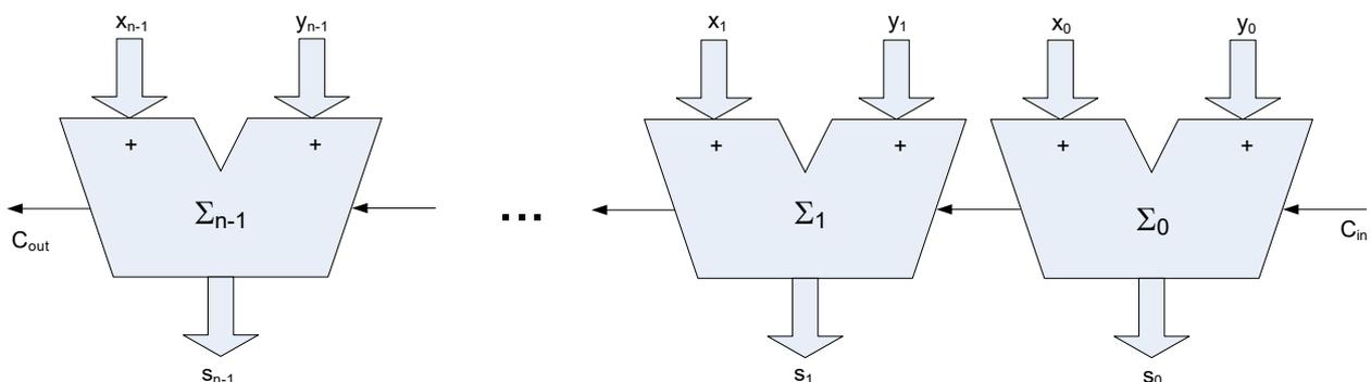
Il montaggio che si ottiene si chiama **ripple carry** (propagazione del riporto). I suoi componenti (sommatori ad una cifra) prendono il nome di **full adder**.
