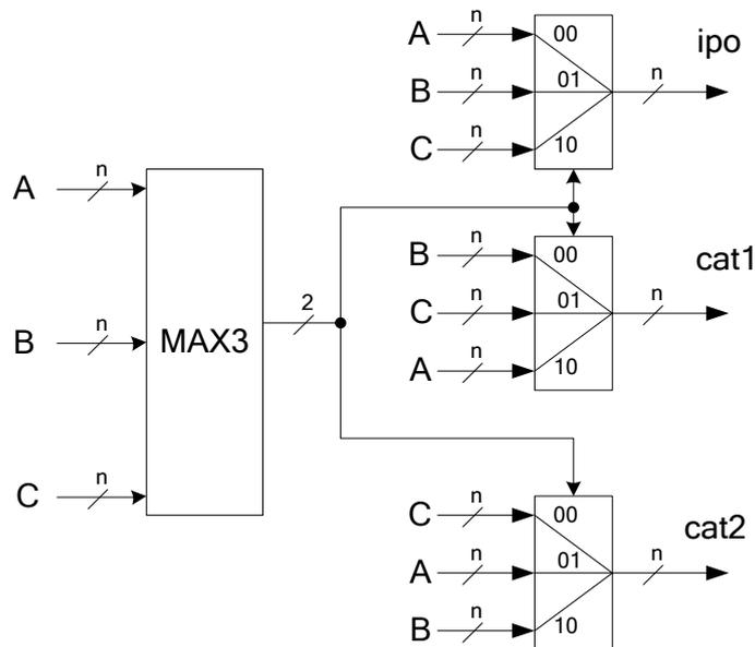
La rete COMP è un comparatore a  $2n + 1$  bit, che può essere realizzato con una barriera di  $2n + 1$  porte XOR seguiti da una porta NOR a  $2n + 1$  ingressi, o dal NOR delle uscite di un sottrattore a  $2n + 1$  bit. Per quanto riguarda la produzione dell'uscita *area*, la rete è la seguente:
