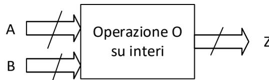
Dirò che il circuito della figura **esegue l'operazione  $O$  sui numeri interi** se, prendendo in ingresso le rappresentazioni  $A, B$ , produce in uscita la rappresentazione  $Z$ , ed è vero che  $a \leftrightarrow A, b \leftrightarrow B, z \leftrightarrow Z$  e  $z = O(a, b)$ . Per realizzare questo circuito dovrò cercare un algoritmo per **calcolare le cifre di  $Z$  sulla base di quelle di  $A, B$** .
