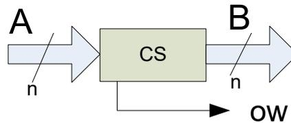
Con  $ow$  segnale di *overflow*, che deve essere messo ad 1 se l'operazione non è possibile, a 0 altrimenti. Per adesso, **assumiamo che  $a \neq -\beta^n/2$**  inizialmente, poi **verificheremo l'ipotesi**.
