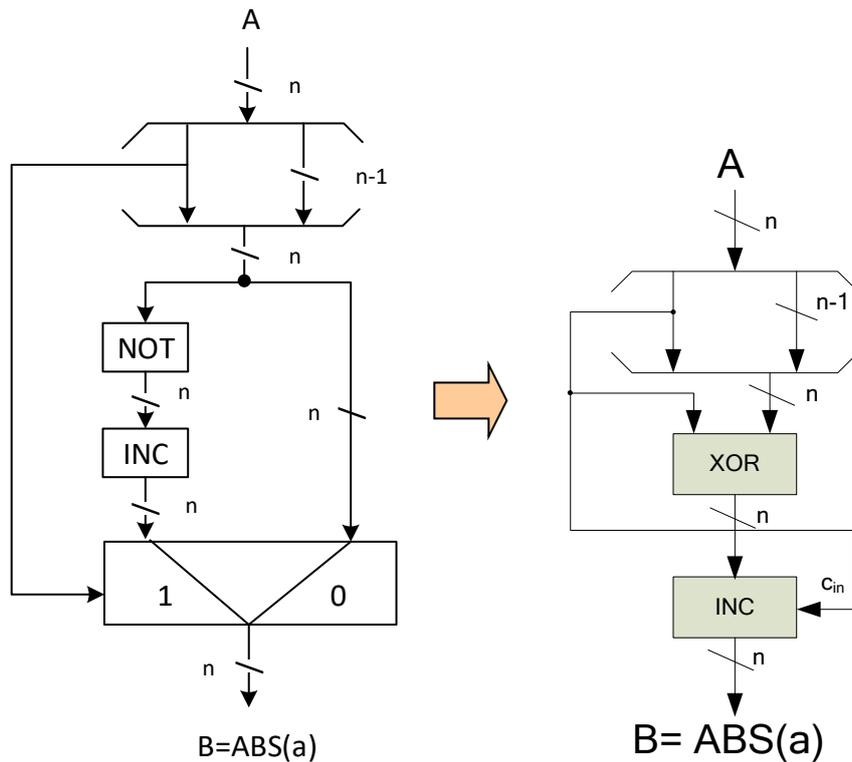
Posso però semplificare ulteriormente, usando una barriera di  $n$  XOR, in cui la porta  $j$ -sima calcola  $a_{n-1} \oplus a_j$ , per realizzare o meno il complemento del numero<sup>2</sup>. Posso poi usare un incrementatore che, sempre guidato dalla cifra più significativa di  $A$ , incrementa il numero o lo lascia invariato.
