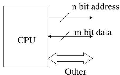
E' possibile indirizzare  $2^n$  locazioni di memoria e trasferire  $m$  bit alla volta
