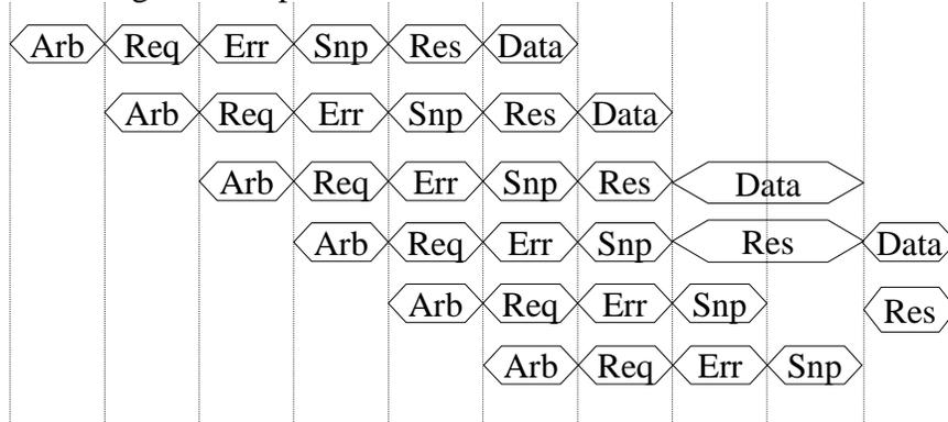
E' necessario che ogni fase utilizzi linee del bus differenti, in modo tale che ogni fase (arb, req, ...) sia indipendente dalle altre
