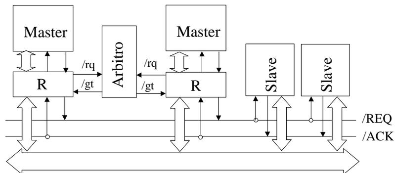
La rete R gestisce l'interazione con l'arbitro e separa le linee del master da quelle del bus quando non lo sta utilizzando.
