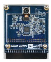
Questo sensore si connette tramite interfaccia parallela mediante l'utilizzo del connettore GPIO 2x20. Oltre a questo probabilmente sarà necessario utilizzare la comunicazione I2C per la regolazione del focus della fotocamera
