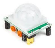
Questo sensore si interfaccia semplicemente tramite un pin di I/O in logica TTL. Il livello logico è alto quando viene rilevato movimento. L'allarme scatterà dopo un intervallo di tempo variabile in base alla sensibilità impostata dall'utente.
