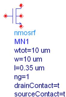
Figura 1.4: Model del transistor NMOS
