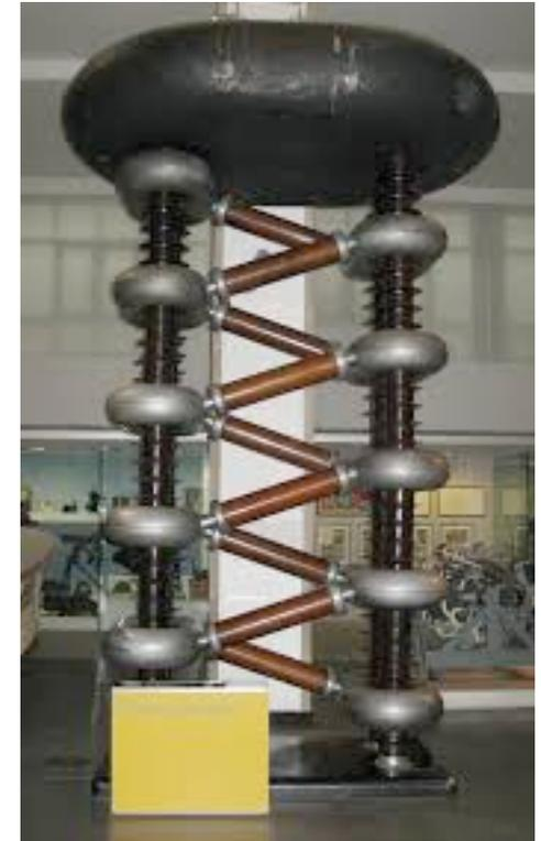
Anche usati come iniettori di altre macchine acceleratrici, come a Fermilab: idrogeno  $\text{H}^-$  (ione negativo) fino a 750 keV
