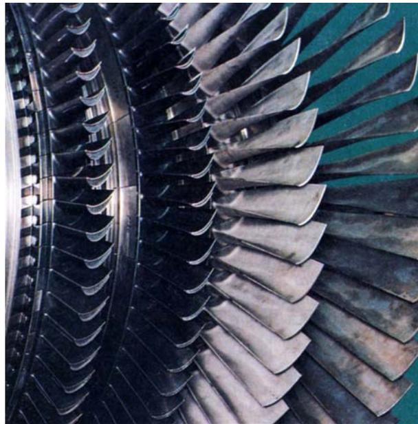
**Figura 9-15:** Svergolamento delle palettaure in una turbina a gas multistadio (molto evidente sulla destra).
