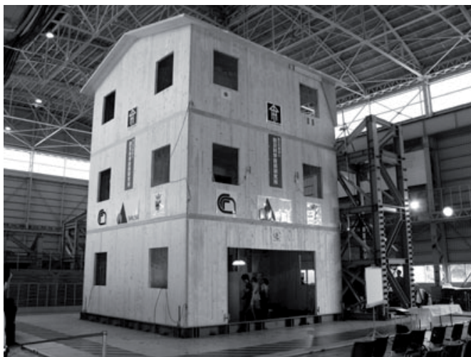
Figura 4.55: Prova su tavola vibrante su un edificio a struttura di legno a pannelli portanti di 3 piani effettuata nel 2006 dal CNR-IVALSA in collaborazione con il National Institute for Earth science and Disaster prevention a Tsukuba, Giappone [10].
