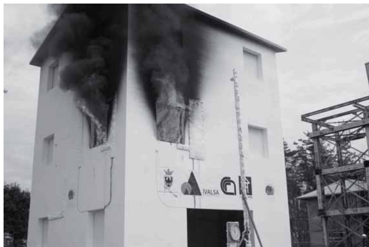
Figura 4.64: Un momento della prova durante la fase di incendio pienamente sviluppato (fonte www.progettosofie.it ).
