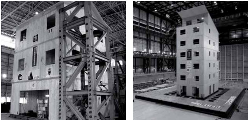
Figura 2: Prove sismiche eseguite dal CNR-IVALSA sulla tavola vibrante del NIED di Tsukuba, Giappone (2006) su un edificio di tre piani e sulla piattaforma sismica sperimentale più grande al mondo, la E-Defence del NIED a Miki nei pressi di Kobe, Giappone (2007) su un edificio di sette piani (fonte www.progettosofie.it ).
