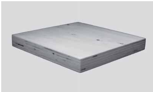
Figura 3.6: porzione di pannello multistrato.
