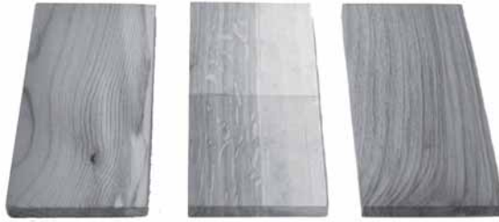
Figura 2.7: aspetto macroscopico di campioni di larice (a sinistra) di quercia caducifolia (al centro) e di noce (a destra). L'immagine in bianco e nero non consente di valutare il colore; nonostante ciò le differenze per quanto riguarda venatura e disegno restano evidenti.
