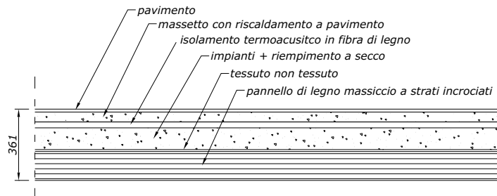
Figura 5.80: Sezione schematica di un solaio.
