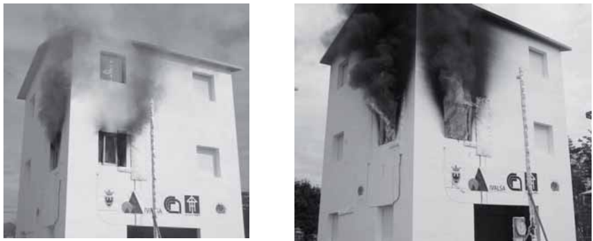
Figura 3: Due momenti della prova di incendio di 60 minuti eseguita dal CNR-IVALSA presso il Building Research Institute, Tsukuba, Giappone (2007) su un edificio di tre piani (fonte: www.progettosofie.it ).
