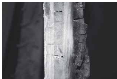
Figura 4.61: Pannello a strati incrociati da 85 mm sottoposto a prova di incendio su forno verticale della durata di 60 min nel 2007 presso il laboratorio di prove al fuoco del CNR-IVALSA a San Michele all'Adige diretto dalla Dott.ssa Giovanna Bochicchio. Nella foto la sezione del pannello al termine della prova; il pannello è formato da 5 strati ognuno di 17 mm, come si nota al termine della prova sono rimasti 3 strati praticamente intatti, pertanto si è avuta una carbonizzazione di 35-40 mm. Nel grafico a destra la variazione di temperatura durante la prova sulla superficie non esposta; mentre sulla faccia esposta al fuoco le temperature sono arrivate quasi a 1000 °C; sulla faccia non esposta si è avuto un aumento di temperatura di soli 7 °C.
