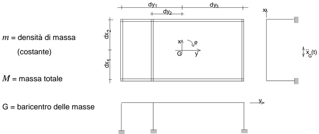
Il sistema strutturale spaziale può pensarsi costituito dall'insieme di telai piani orditi secondo  $x$  e secondo  $y$ ; in generale si avranno  $s$  telai orditi in direzione  $x$  di rigidezza laterale  $K_x$  e  $t$  telai orditi in direzione  $y$  di rigidezza laterale  $K_y$ . In genere, è lecito trascurare la rigidezza dei telai fuori del loro piano e la rigidezza torsionale dei pilastri, in quanto molto piccole rispetto al contributo fornito dalla rigidezza laterale dei telai piani.
