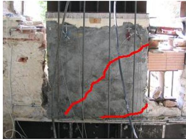
Figura 8. Pannello B consolidato dopo la prova 8, vista interna.
