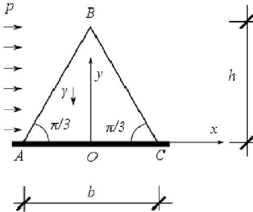
Nel problema piano nella tensione mostrato nella figura, una lastra, di piccolo spessore e avente la forma di un triangolo equilatero è incastrata in corrispondenza della sua base AB. Sulla lastra, oltre che al peso proprio, agisce un carico distribuito orizzontale, di intensità  $p$  per unità di lunghezza nella direzione  $y$ .
