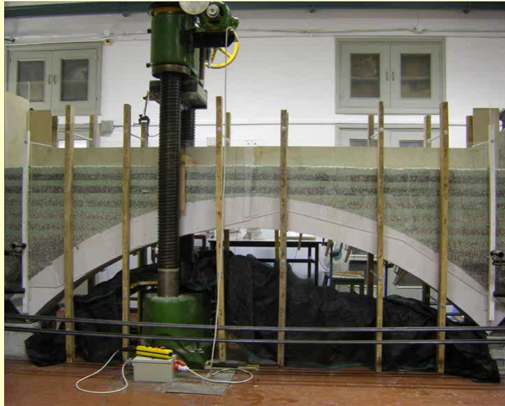
Sperimentazione su modelli - Effetto del riempimento - A. Brencich
