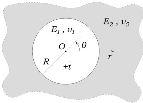
1) Dato che il sistema è dotato di simmetria polare, sia le tensioni che le deformazioni e gli spostamenti non dipendono dall'angolo  $\theta$ , ma, al più, da  $r$ ; ogni asse radiale è inoltre anche asse di simmetria ortogonale per il sistema, per cui sia le tensioni tangenziali  $\tau_{r\theta}$  che la componente tangenziale  $v$  dello spostamento devono essere nulli  $\forall r$ .
