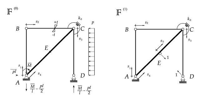
Le CdS nei vari tratti sono, nei due sistemi le seguenti (con  $s_1, s_2$  e  $s_3 \in [0, l]$  e  $s_4$  e  $s_5 \in [0, l/\sqrt{2}]$ ):
