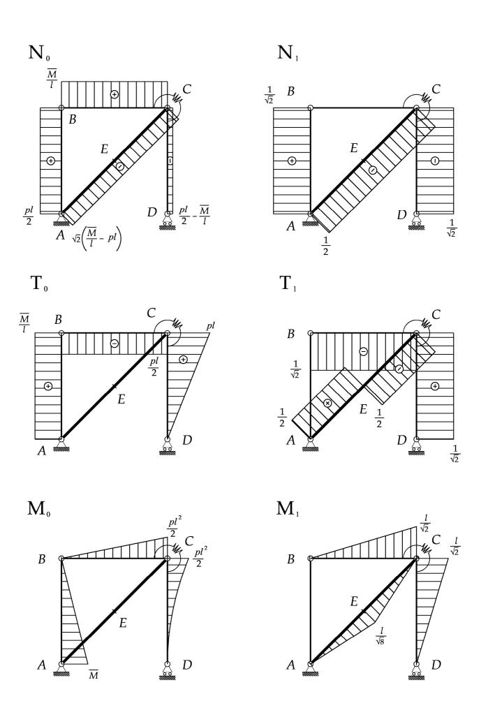
Nota. Nel disegno del diagramma di  $N_0$  si è supposto  $\overline{M} = \frac{10}{16} p l^2$ .
