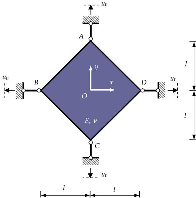
1) Nei punti dell'elemento elastico piano di figura, costituito da un materiale di Lamé, e vincolato in A, D, C e B con quattro pendoli rigidi, ciascuno dei quali subisce il cedimento anelastico indicato, è assegnato il campo di spostamento seguente,
