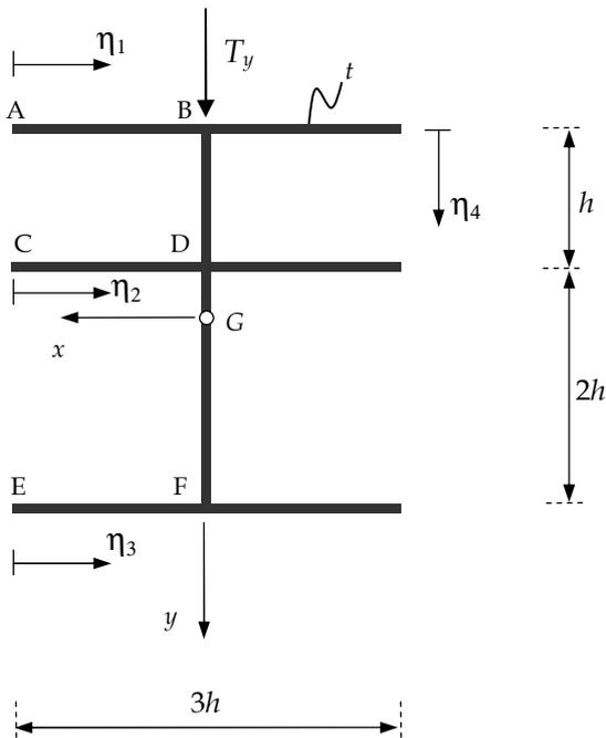
Esercizio 1. La sezione sottile aperta di figura è soggetta ad una forza di taglio d'intensità  $T_y$  diretta lungo l'asse  $y$ .
