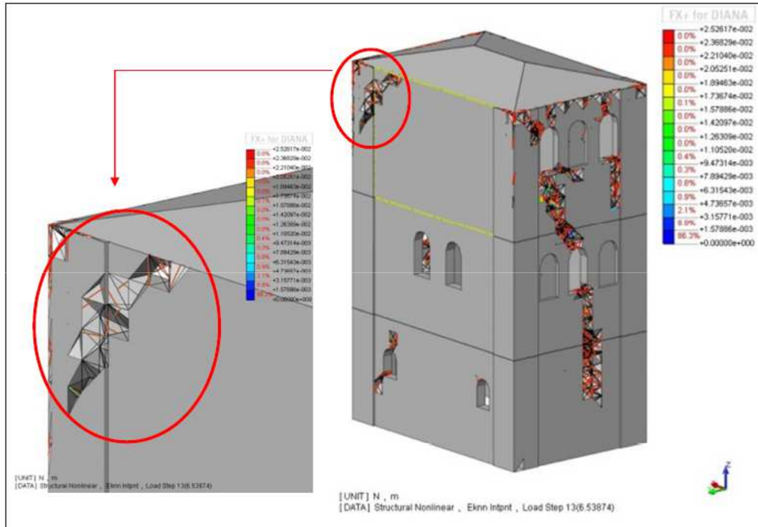
Fig. 4.51: Crack Pattern Direzione: -Y, Eccentricità: e > 0 , Materiale: Total Strain Crack Model, Taglio alla base: 827 kN; Spostamento: 10 mm
