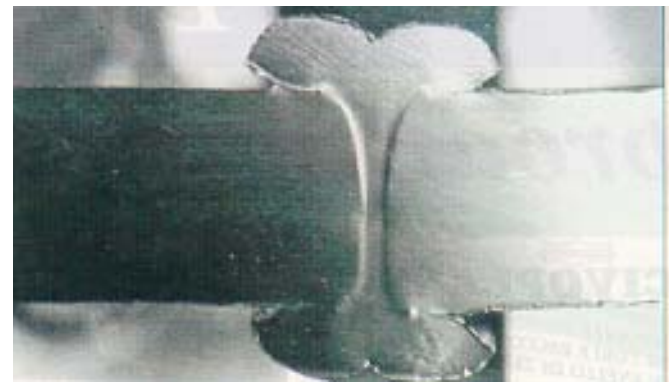
Sezione conforme, pressione di saldatura corretta
