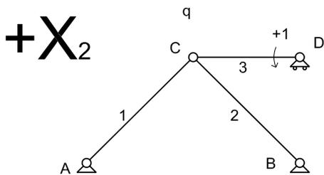
Per il computo dei vincoli, si ha  $2 + 2 + 2 \cdot 2 + 2 + 1 - 3 \cdot 3 = 2$  la struttura è 2 volta iperstatica. Come incognita iperstatica  $X_1$  scegliamo la reazione orizzontale in  $D$  e come incognita iperstatica  $X_2$  la reazione della molla. Gli spostamenti generalizzati corrispondenti nel sistema effettivo valgono:
