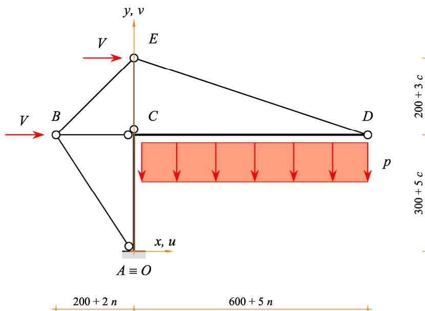
Il materiale è acciaio con modulo elastico  $E = 21.000,00 \text{ kN/cm}^2$ . Le travi  $AC$  e  $CD$  sono realizzate con profili **IPE 400** di parametri  $A_t = 84,50 \text{ cm}^2$  e  $J_t = 23.130,0000 \text{ cm}^4$ . Le aste restanti sono dei profili tubolari di parametri  $A = 33,90 \text{ cm}^2$  e  $J = 1.250,0000 \text{ cm}^4$ . I carichi hanno intensità  $V = 20 \text{ kN}$  e  $p = 0,20 \text{ kN/cm}$ , rispettivamente.
