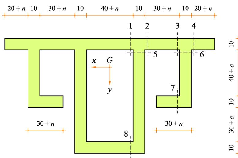
Calcolare i valori in  $\text{kN/cm}^2$  della tensione ideale nelle 8 sezioni indicate, facendo le seguenti ipotesi:
