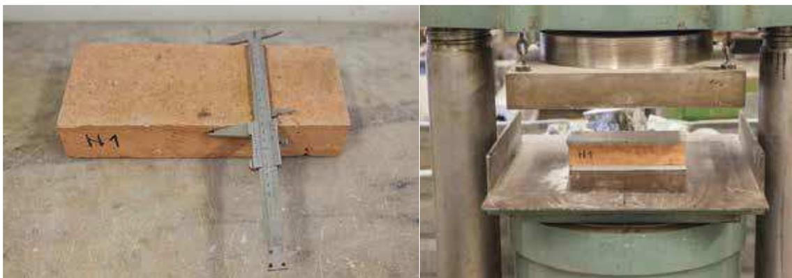
3 - Misurazione e prova di carico su un provino di laterizio
