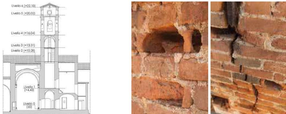
2 - Sezione verticale e dettagli dello stato di conservazione della muratura
