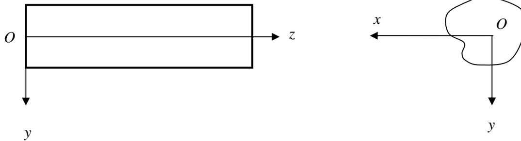
Nei punti del cilindro mostrato in figura (l'origine del sistema di riferimento coincide con il baricentro della sezione di base, gli assi  $x$  e  $y$  sono orientati lungo le direzioni principali d'inerzia della sezione stessa) è definito il campo di tensioni:
