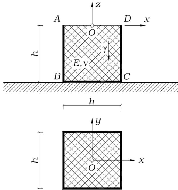
Un materiale granulare, avente peso specifico  $\gamma$ , riempie il contenitore cubico mostrato in figura.
