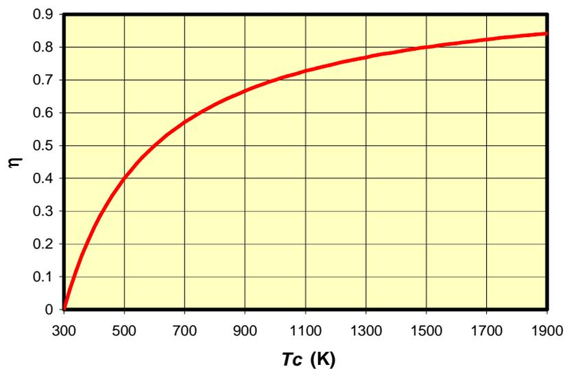
**Figura 6.4:** Rendimento della macchina di Carnot; la temperatura della sorgente fredda, ovvero dell'ambiente, è fissata a 300 K.
