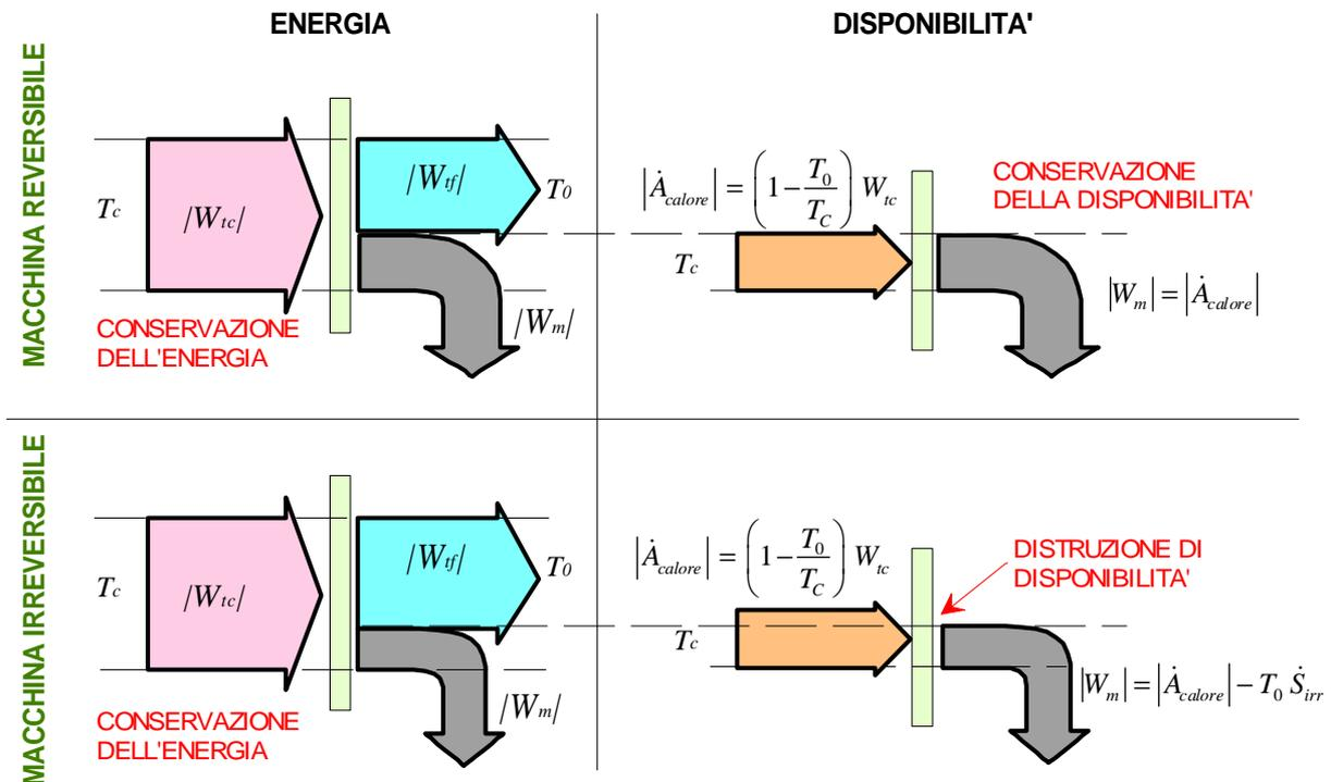
**Figura 6.10:** Flusso di energia e disponibilità in una macchina termica motrice semplice con temperatura inferiore pari a quella dello stato morto ( $T_c = T_F$ ). In questo caso lo scambio di disponibilità termica con la sorgente fredda è nullo.
