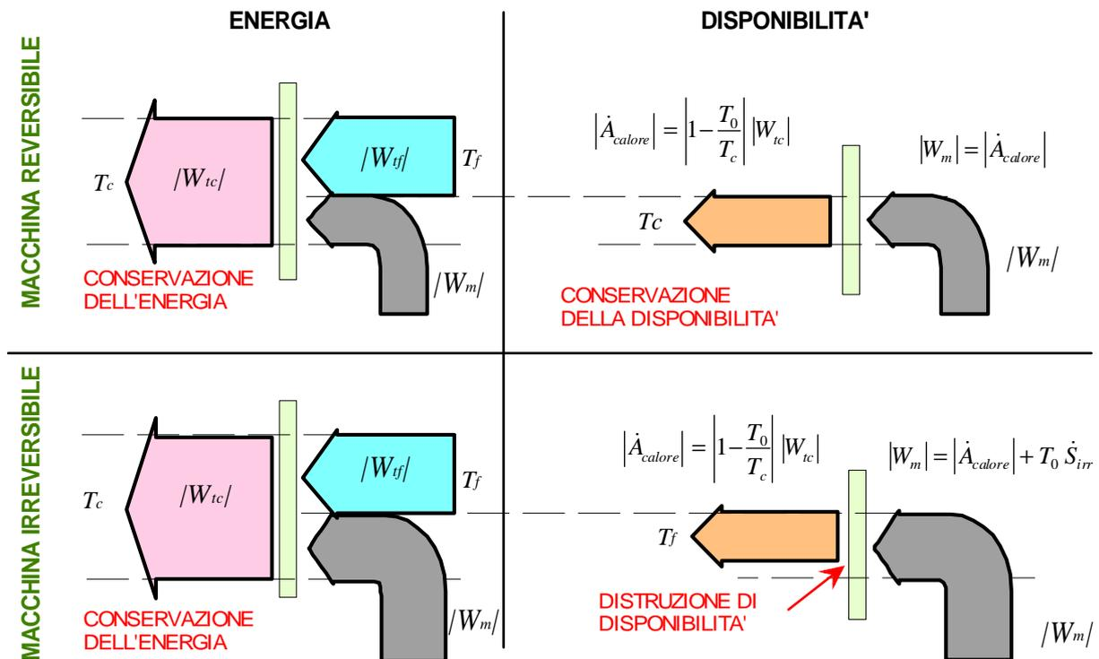
**Figura 6.11:** Flusso di energia e disponibilità in una macchina termica frigorifera semplice con temperatura inferiore pari a quella dello stato morto ( $T_0 = T_f$ ). In questo caso lo scambio di disponibilità termica con la sorgente fredda è nullo.
