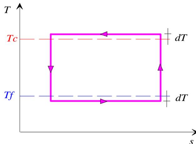
**Figura 6.6:** Ciclo termodinamico della macchina semplice operatrice reversibile.
