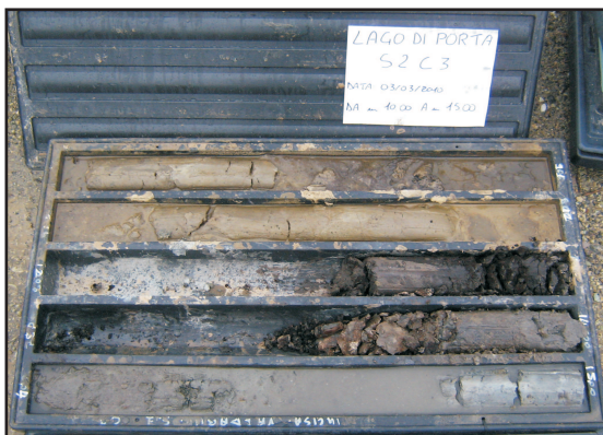
Sondaggio n. 2 - Stratigrafia da 10.00 m a 15.00 m -
