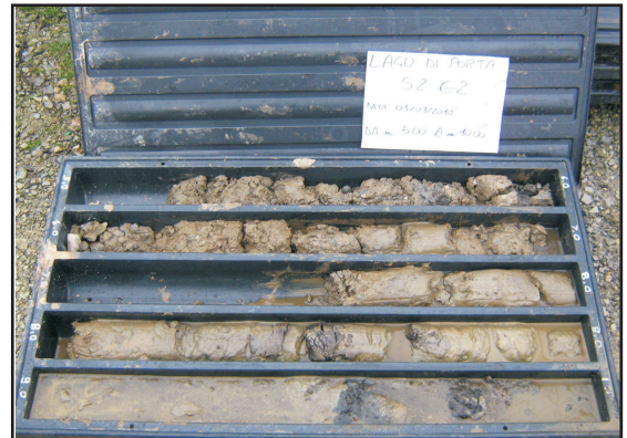
Sondaggio n. 2 - Stratigrafia da 5.00 m a 10.00 m -
