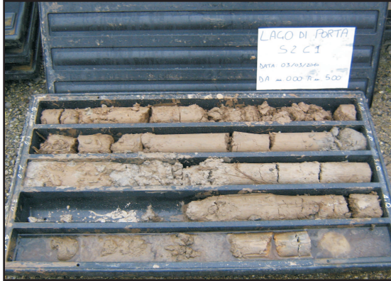
Sondaggio n. 2 - Stratigrafia da 0.00 m a 5.00 m -
