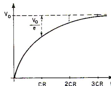
Il termine  $T=RC$  è un elemento caratteristico del circuito e viene detto *Costante di tempo del circuito*.
