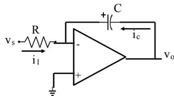
Per le caratteristiche dell'amplificatore operazionale  $i_1 = -i_c$
