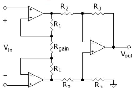
È una configurazione differenziale che permette di migliorare l'impedenza di ingresso: non vengono "caricati" i sistemi sotto misura. Impedenza di ingresso  $> 100 \text{ M}\Omega$ .
