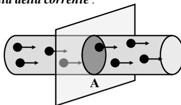
L'unità di misura della corrente è l'**ampere**; 1 ampere equivale al flusso della carica di 1 coulomb al secondo.
