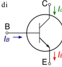
Si deve notare la differenza tra i valori della corrente di base e quelli della corrente di collettore
