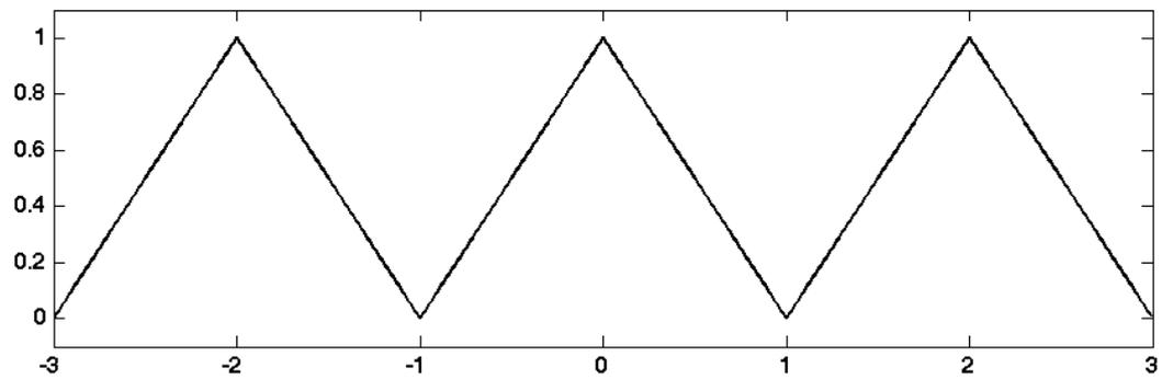
I coefficienti dell'onda triangolare sono  $S_0 = 0.5$  e  $S_n = 0.5 \frac{\sin^2\left(\frac{\pi n}{2}\right)}{\left(\frac{\pi n}{2}\right)^2}$ .
