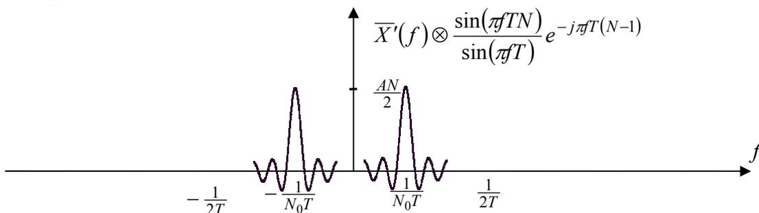
Nel seguito viene mostrato un esempio dello spettro di due segnali cosinusoidali e l'effetto della finestra di osservazione, in un caso probabilmente insufficiente per distinguerne i contributi (si deve far notare che nel secondo grafico i contributi delle finestre sono stati sovrapposti e non sommati come sarebbe opportuno).
