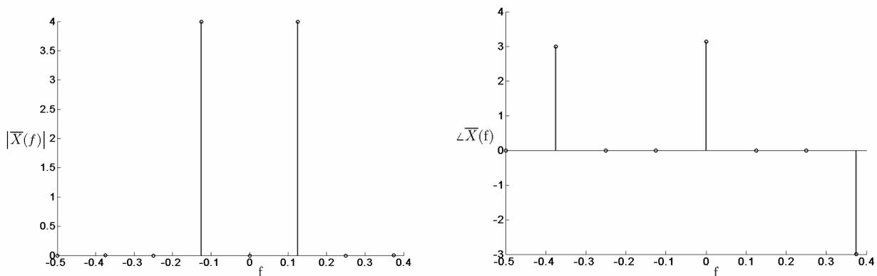
Vediamo l'effetto dello zero padding prima di  $N=16$ , poi con  $N=20$  e  $N=100$ . Si nota la possibilità di evidenziare l'effetto della finestra di osservazione. Si deve precisare che la finestra di osservazione è sempre pari a 8 secondi.
