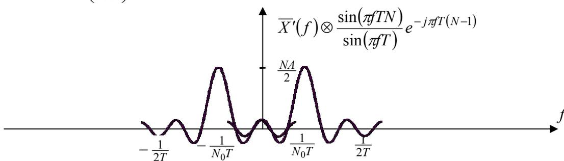
Si fa notare che  $x'[n]$  è una sequenza periodica, e l'ampiezza della finestra è pari al periodo del segnale, in corrispondenza di  $\frac{k}{NT} = \frac{k}{N_0T}$  si avranno o il valore di picco della finestra o i valori corrispondenti al passaggio per lo zero, evitando effetti distortivi. Fenomeno analogo si avrà nel caso in cui la grandezza della finestra sarà un multiplo del periodo della funzione.
