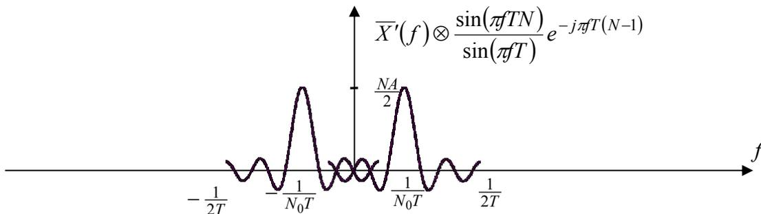
Ovvero le trasformate delle funzioni a gradino vengono centrate in corrispondenza delle delta di Dirac.
