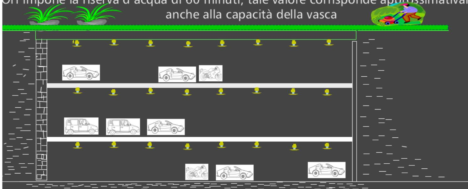
$$Q_{\text{sprinkler litri/min.}} = (\text{fattore}) K_x \sqrt{P_{\text{funzionamento}}} \rightarrow 80 \times \sqrt{0,5} = 56,5 \text{ l/m}$$
