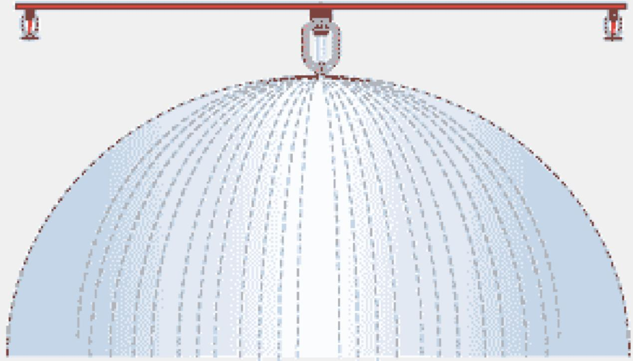
**Spray:** erogatore che produce un getto d'acqua di forma paraboloidica diretto essenzialmente verso il pavimento, su un'area definita;
