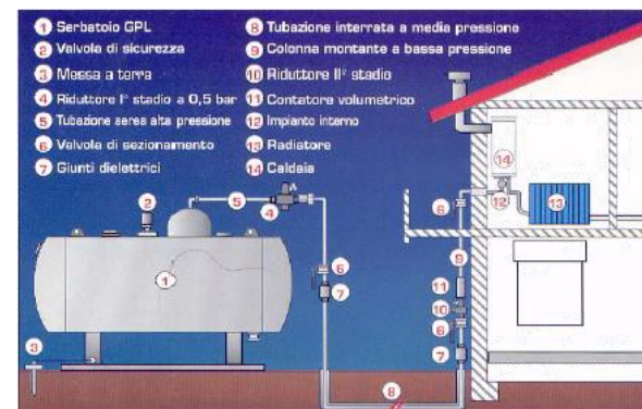
schema di installazione tipo di impianto domestico
