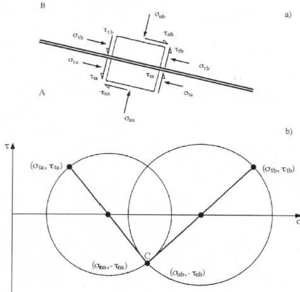
Fig. 2.12. Stato di sforzo su di una discontinuità tensionale
