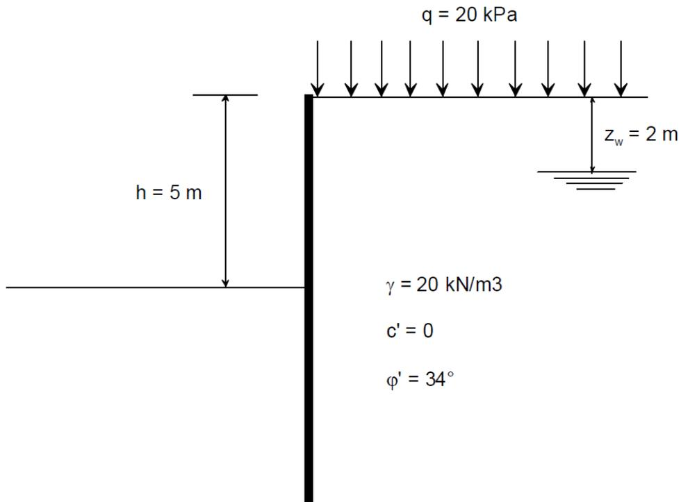
Dimensionare la lunghezza della struttura di sostegno con riferimento alle Norme Tecniche per le Costruzioni 2008.
