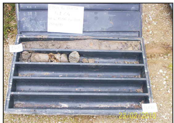
Sondaggio n. 1 - Stratigrafia da 15.00 m a 20.00 m -
