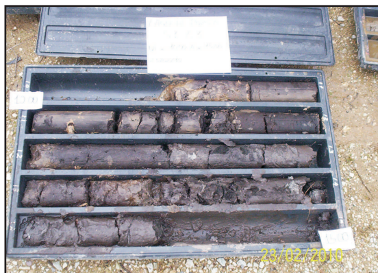
Sondaggio n. 1 - Stratigrafia da 10.00 m a 15.00 m -
