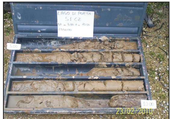
Sondaggio n. 1 - Stratigrafia da 5.00 m a 10.00 m -
