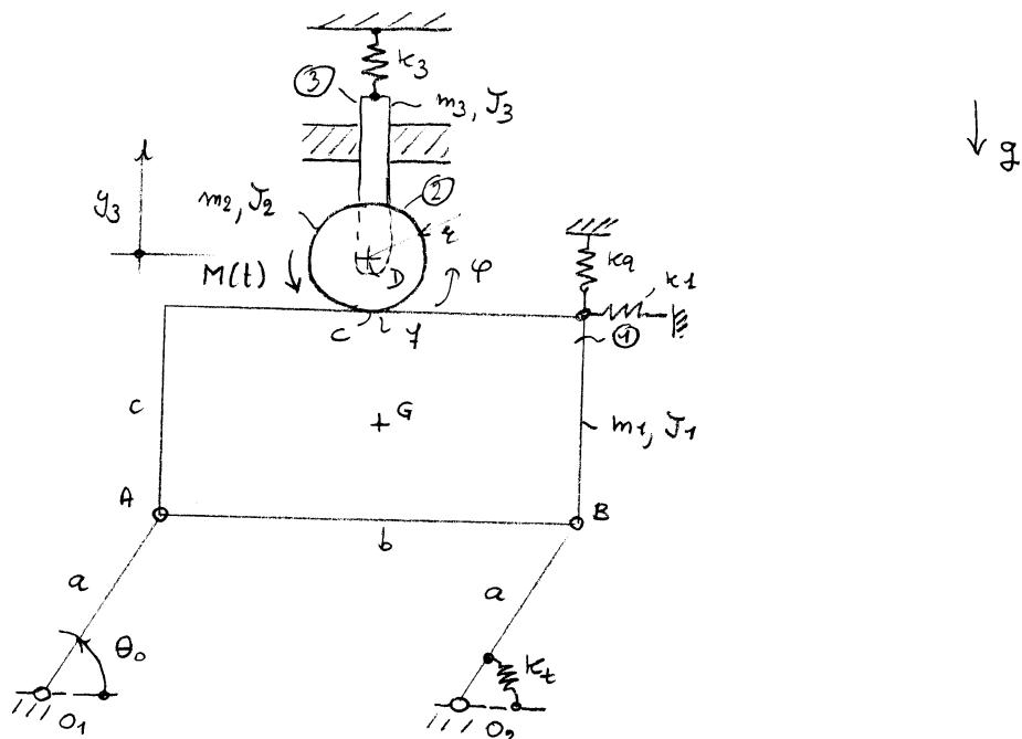
Dati: asti alle basi ferre di massa. Nella config. disegnata  $\theta_0 = 60^\circ$ ,  $k_1$  e  $k_2$  sono scaricate, mentre  $k_3$  è precaricata. La molla di torsione  $k_t$  è a riposo quando  $O_2B$  è verticale. Per  $t > 0$  agisce sul disco un momento  $M(t) = M_0 \sin(-\omega t)$
