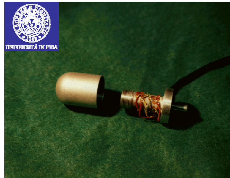
Sensore F/T a 6 assi miniaturizzato, usato come sensore tattile intrinseco (UNI PISA)
