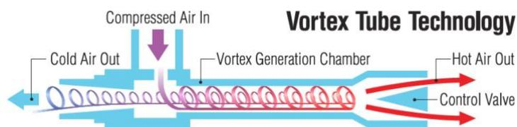
Il tubo di Ranque - Hilsch, detto anche tubo a vortice, è un dispositivo che consente di separare un flusso di aria compressa in due getti separati, caratterizzati da una
