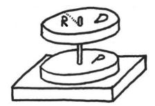
Si abbia una base motorizzata che mantiene in rotazione un piatto (oggetto P in figura) a velocità angolare costante  $\omega_0=33,\bar{3}$  giri/minuto. Al piatto è connesso un perno verticale concentrico e sottile. Sul perno può scorrere, verticalmente e senza nessun attrito, un disco (oggetto D in figura) di raggio R=15cm, minore o uguale a quello del piatto. Il disco, praticamente fermo, viene appoggiato delicatamente sul piatto e lasciato
