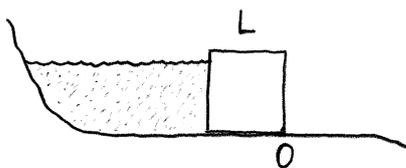
Schematizziamo la diga che crea un lago artificiale come un lungo parallelepipedo a sezione quadrata di lato  $L$  (vedi figura), tenuto in posizione esclusivamente dal proprio peso ed appoggiato sul fondo roccioso, assunto essere piano e ben rugoso.
