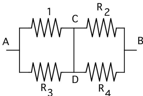
Una DDP costante di 25 Volt viene applicata agli estremi  $A$  e  $B$  del circuito in figura. Trovare la corrente che passa attraverso il ramo  $CD$ , in modulo e verso, se le resistenze valgono  $R_1=1\Omega$ ,  $R_2=2\Omega$ ,  $R_3=3\Omega$ ,  $R_4=4\Omega$ .
