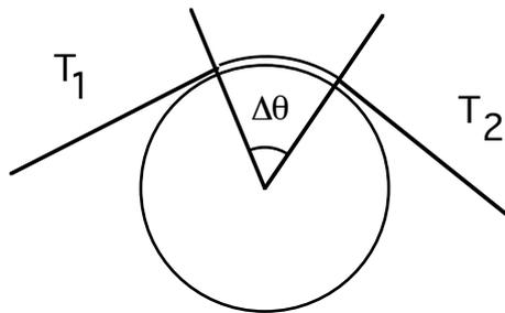
Una corda è piegata intorno ad un palo di un angolo  $\Delta\theta$  molto piccolo, come in figura. Il coefficiente di attrito fra la corda ed il palo è  $\mu$ . Se si tira la corda con una piccola velocità la tensione risulta  $T_1 = T_2 + \Delta T$ , dove  $\Delta T$  è dovuta all'attrito. Determinate  $\Delta T$  in funzione di  $T$ ,  $\mu$  e  $\Delta\theta$ .
