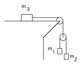
Nel sistema in figura le masse sono note e valgono  $m_1$ ,  $m_2$  ed  $m_3$ . Non c'è attrito e le masse di funi e carrucole sono trascurabili. Trovare l'accelerazione del corpo di massa  $m_1$ .
