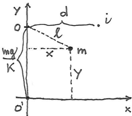
CONVIENE PRENDERE UN SISTEMA X-Y COME IN FIGURA, CON L'ORIGINE O' NEL PUNTO DI EQUILIBRIO, IL QUALE PER UNA MASSA APPESA AD UNA MOLLA GIACE UNA DISTANZA  $\frac{mg}{K}$  AL DI SOTTO DEL PUNTO DI SOSPENSIONE O.
