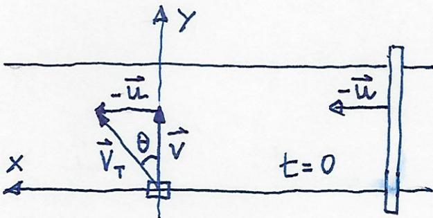
PER PRIMA COSA, SI SCEGLIE UN SISTEMA DI RIFERIMENTO SOLIDALE AL NASTRO TRASPORTATORE PRINCIPALE, DOVE ESSO E' FERMO.
