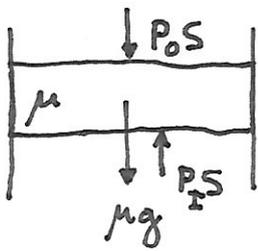
DURANTE IL MOTO DI UNO QUALUNQUE DEI DUE PISTONI, DETTA  $\mu$  LA SUA MASSA ( $\mu = m$  OPPURE  $m$ ),  $S$  LA SEZIONE DEL CILINDRO E  $P_I$  LA PRESSIONE INTERNA, SI HA
