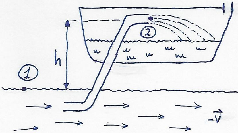
METTIAMOCI NEL SISTEMA DI RIF. DELL'AEREO. TUBO E SERBATOIO SONO FERMI, L'ACQUA DEL MARE O DEL LAGO VIAGGIA A VELOCITÀ  $-\vec{V}$
