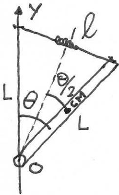
DETTA  $l$  LA LUNGHEZZA DELLA MOLLA IN UNA POSIZIONE GENERICA E  $\theta$  L'ANGOLI D'INCLINAZIONE VERTICALE DELLA SBARRA, SCRIVIAMO L'EQUAZIONE DELL'ENERGIA POTENZIALE DEL SISTEMA
