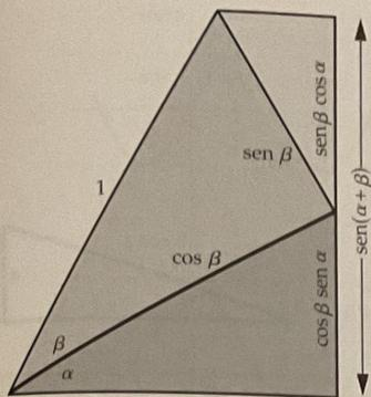
**FIGURA M.14** Usando questo disegno, si derivi l'identità  $\text{sen}(\alpha + \beta) = \text{sen} \alpha \cos \beta + \cos \alpha \text{sen} \beta$ . Lo stesso disegno può essere usato per derivare l'identità  $\text{cos}(\alpha + \beta) = \text{cos} \alpha \cos \beta - \text{sen} \alpha \text{sen} \beta$ .
