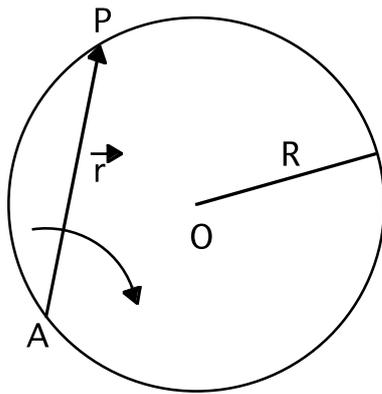
Un punto materiale P si muove su una circonferenza di raggio  $R$ , centrata in  $O$ , in modo tale che il suo vettore posizione  $\mathbf{r}$ , relativo al punto  $A$  che giace sulla circonferenza, ruota con velocità angolare costante  $\omega$ . Trovare il modulo della velocità del punto P, nonché modulo e direzione della sua accelerazione.
