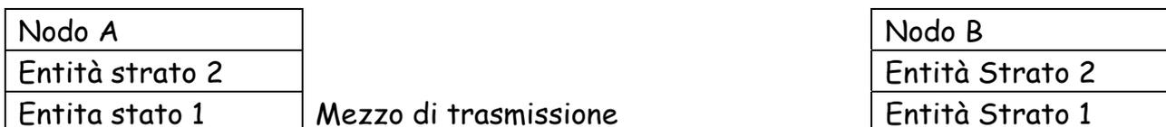
Se A vuole trasmettere a B, l'entità di livello 2 del nodo A ordina all'entità di livello 1 di trasmettere i dati. L'entità di livello 1 del nodo A li invia sul mezzo di trasmissione.
