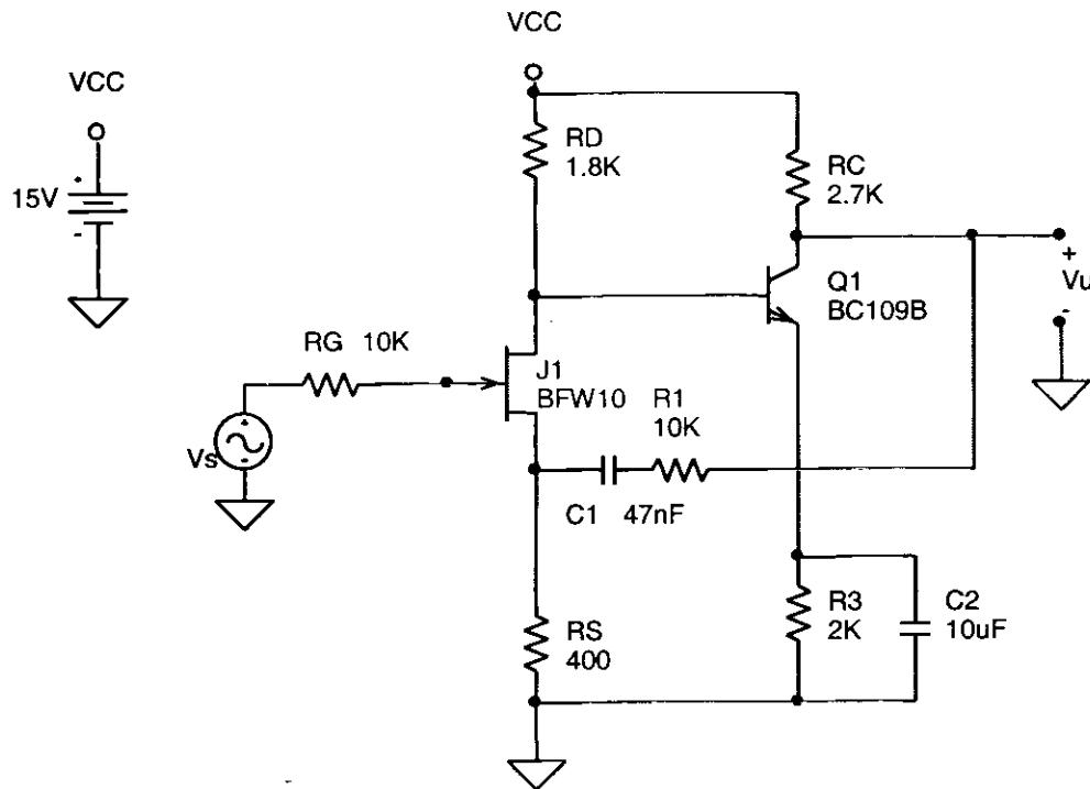
Le tensioni di alimentazione sono  $V_{CC} = 15$  V.  $J1$  è un BFW10 resistivo, con  $r_d$  infinita,  $Q1$  è un BC109B resistivo con  $h_{oe} = 0$ ,  $h_{re} = 0$ .
