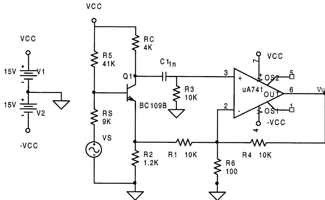
L'operazionale è un  $\mu$ A741 con  $A_{vol0}=250000$  e  $f_p=4$  Hz, Q1 è un BC109B resistivo, con  $h_{oe}=0$ ,  $h_{re}=0$ .
